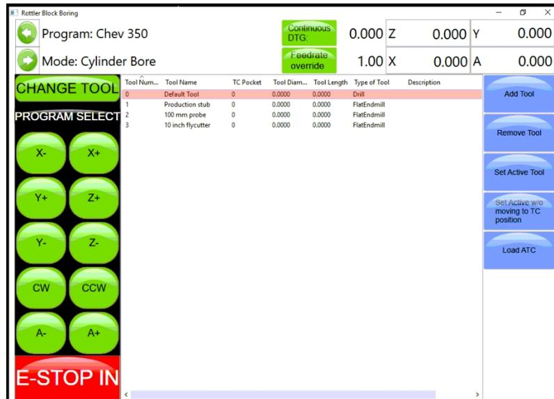
Para ajustar los Offsets de Herramienta necesitará un punto de referencia vertical fijo en la máquina que no cambie, como el cabezal del 4º eje o el Fixture de Rendimiento.
