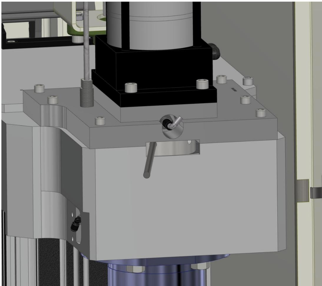
Tenez le porte-outil et tournez-le d'un tour dans le sens des aiguilles d'une montre pour desserrer le réglage de la broche intérieure.
