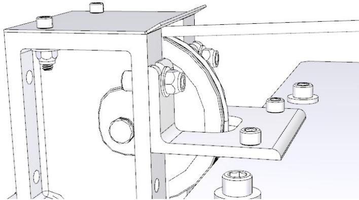
10. Retirez les couvercles en tôle à l'arrière pour accéder au cylindre de contrepoids.
