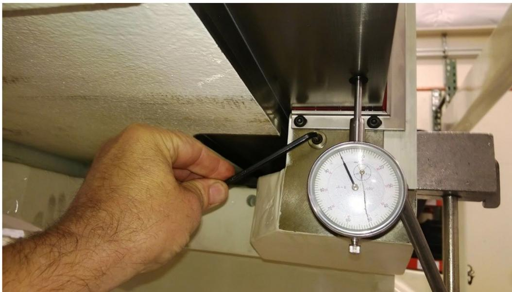
3. l'aide d'une clé hexagonale de 3/16", tournez la vis de réglage dans le sens inverse des aiguilles d'une montre pour augmenter ou réduire l'inclinaison de la fraise dans le sens inverse des aiguilles d'une montre. Après chaque réglage, appuyez sur le bouton "Wedge On" pour vérifier la valeur. Réglez la quantité de levage entre 0,002 et 0,004" (0,05-0,10 mm). Désactivez la cale pour effectuer un nouveau réglage.
