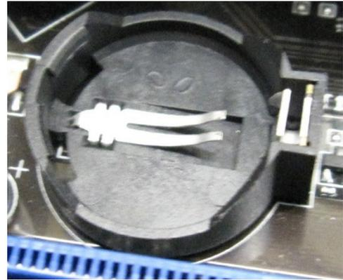
Du bout du doigt, poussez la batterie vers le bas jusqu'à ce que le clip de rétention soit en position de verrouillage.
