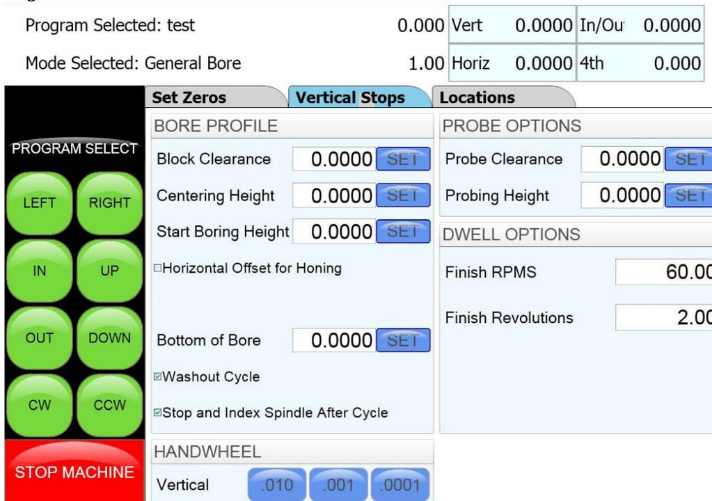
12. Eloignez la broche de la machine de quelques centimètres du plongeur et appuyez sur "Move to". Entrez 0 pour la valeur et appuyez sur "Enter" pour l'axe mesuré.
