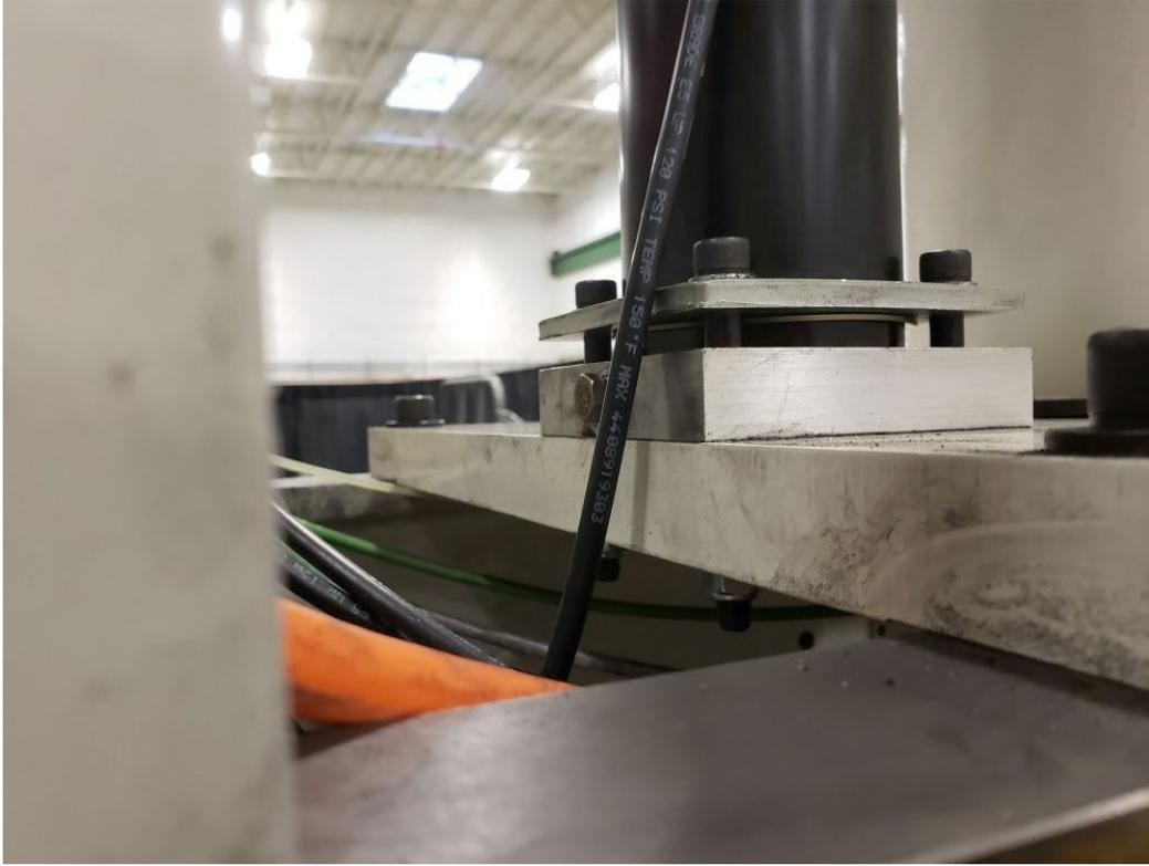
12. Boulonner la partie supérieure du cylindre au support de la plaque supérieure et réinstaller le couvercle supérieur.
