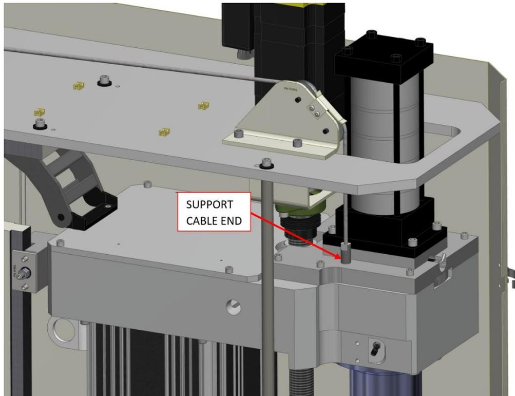
Retirer le moteur de l'axe Z et le support de la vis à billes.
