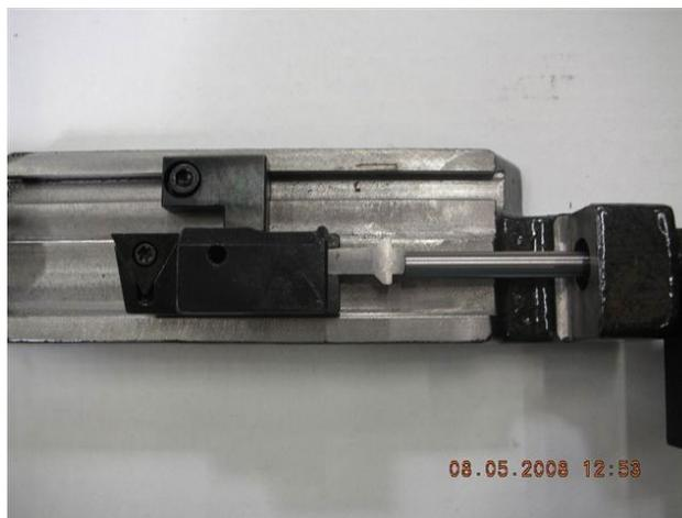
Faites glisser l'enclume de grand diamètre vers le haut jusqu'à ce qu'elle touche l'extrémité de la pointe de coupe du porte-outil. Serrer la vis de réglage.
