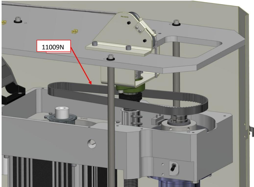
Lorsque la nouvelle courroie est en place, utilisez le boulon de réglage pour régler la tension de la courroie. La tension est correcte lorsqu'il y a une déflexion de 4,3 mm (0,17 pouce) lorsque l'on applique une force de 7,7 à 8,3 livres entre les deux poulies.
