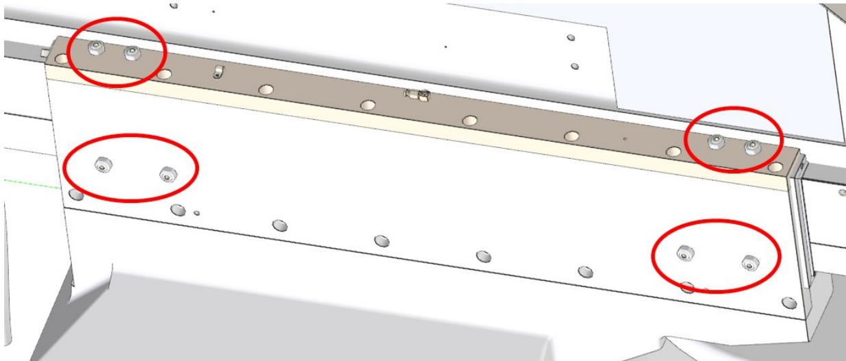
Sur le côté droit de la colonne, des cales sont situées sur le rail supérieur.
