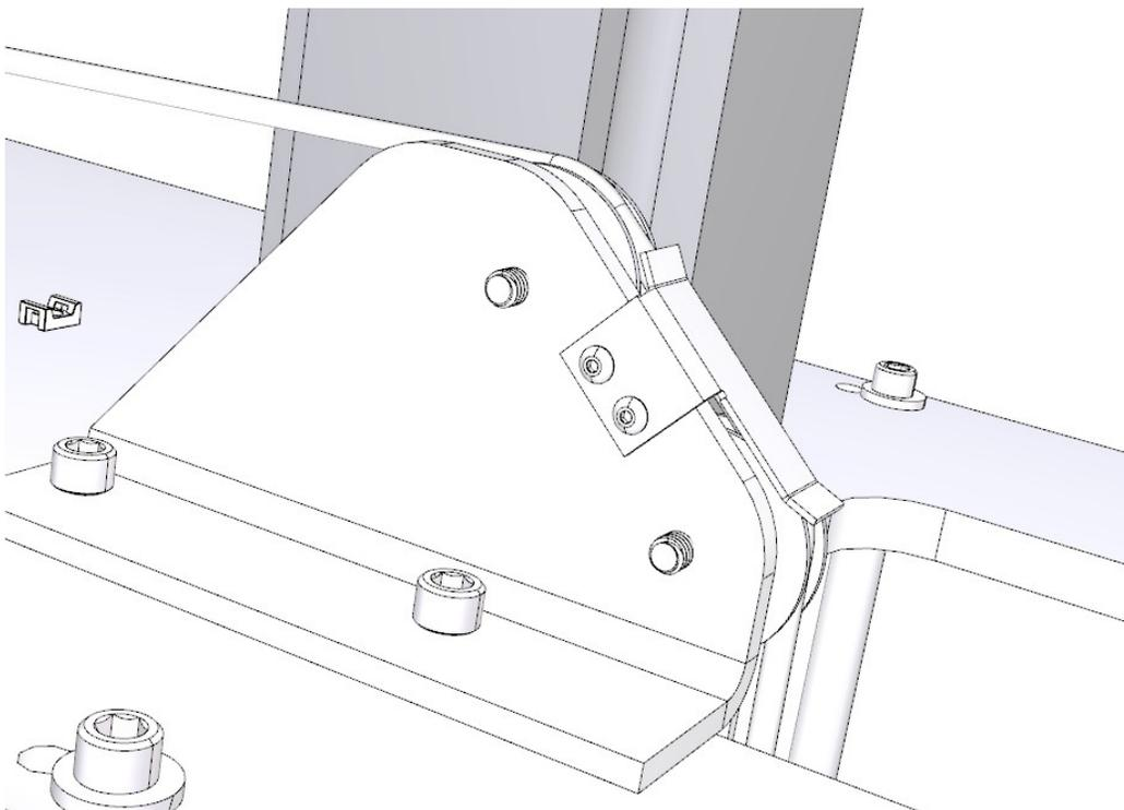
8. Retirer le couvercle supérieur du cylindre et le mettre de côté.
