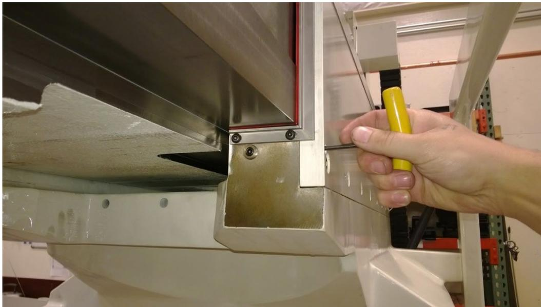
2. Mettez la machine en mode "Cycle de broyage", avec la cale éteinte. Fixez un indicateur comme indiqué sur la photo suivante et réglez-le sur zéro.
