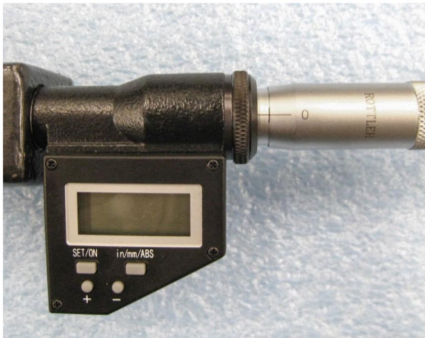
Déterminez la plage d'alésage du porte-outil sur laquelle le micromètre sera utilisé. (exemple : 2,9 - 6,0) Nous voulons initialement régler le micromètre sur le diamètre d'alésage minimum de ce porte-outil.
