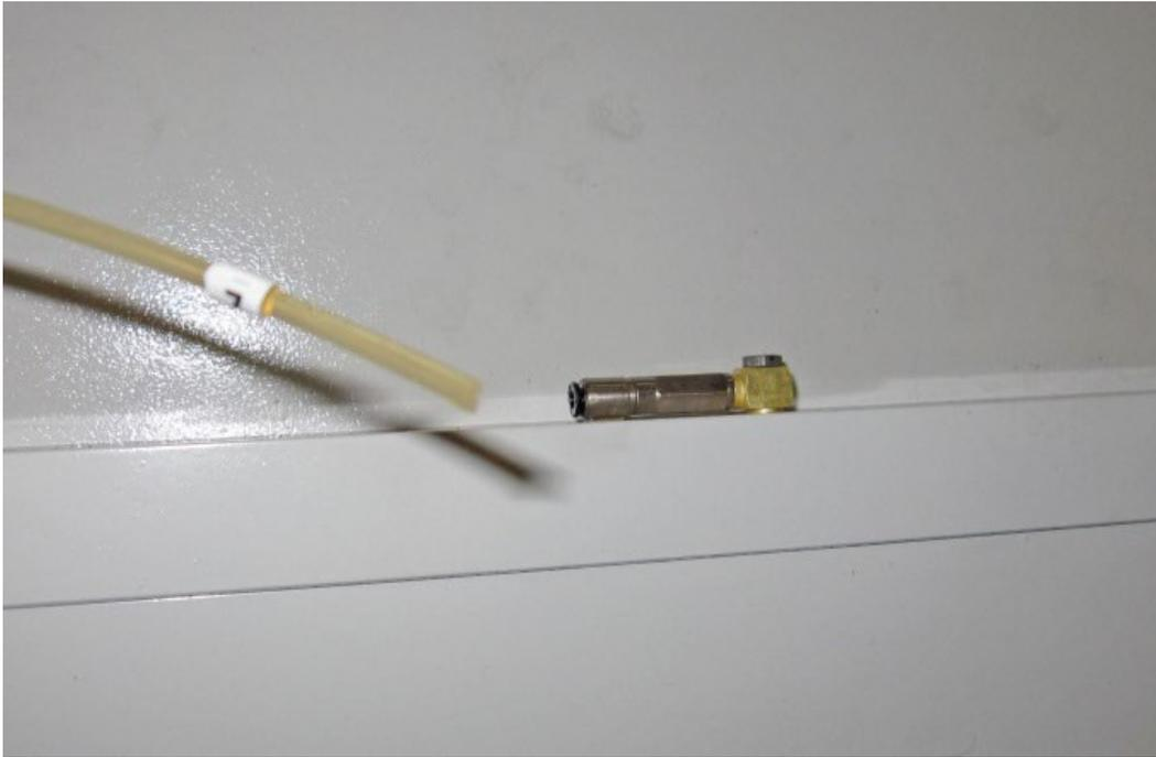
3. Activez le bit IO du graisseur sur l'ordinateur et attendez que l'huile s'écoule de la conduite.
