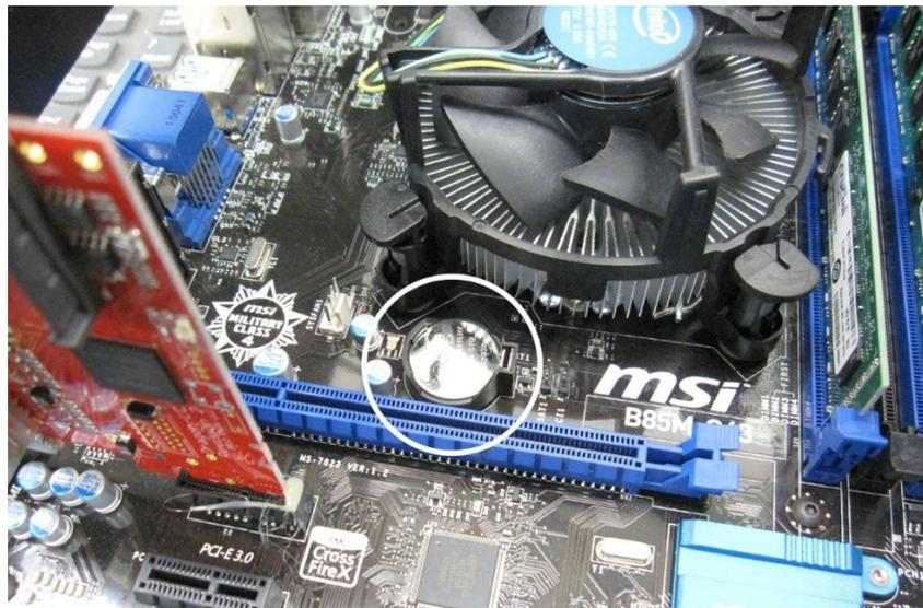
Poussez le clip de rétention de la batterie en l'éloignant de la batterie. Lorsque le clip est relâché, la batterie se soulève.
