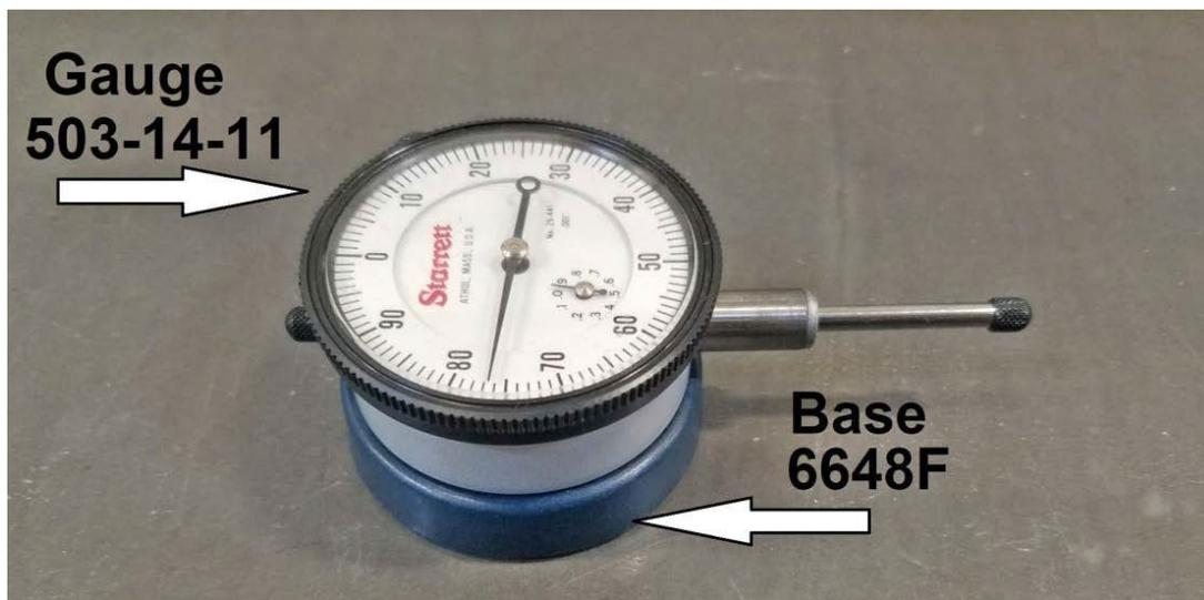
Si l'axe dépasse ou se met en position lentement, vous pourrez le voir avec un comparateur. Avec l'indicateur numérique, vous ne verrez que la position finale. L'indicateur Magnascale doit être utilisé pour composer ou tramer. Les mouvements automatiques de la machine peuvent "choquer" le plongeur sensible du Magnascale.
