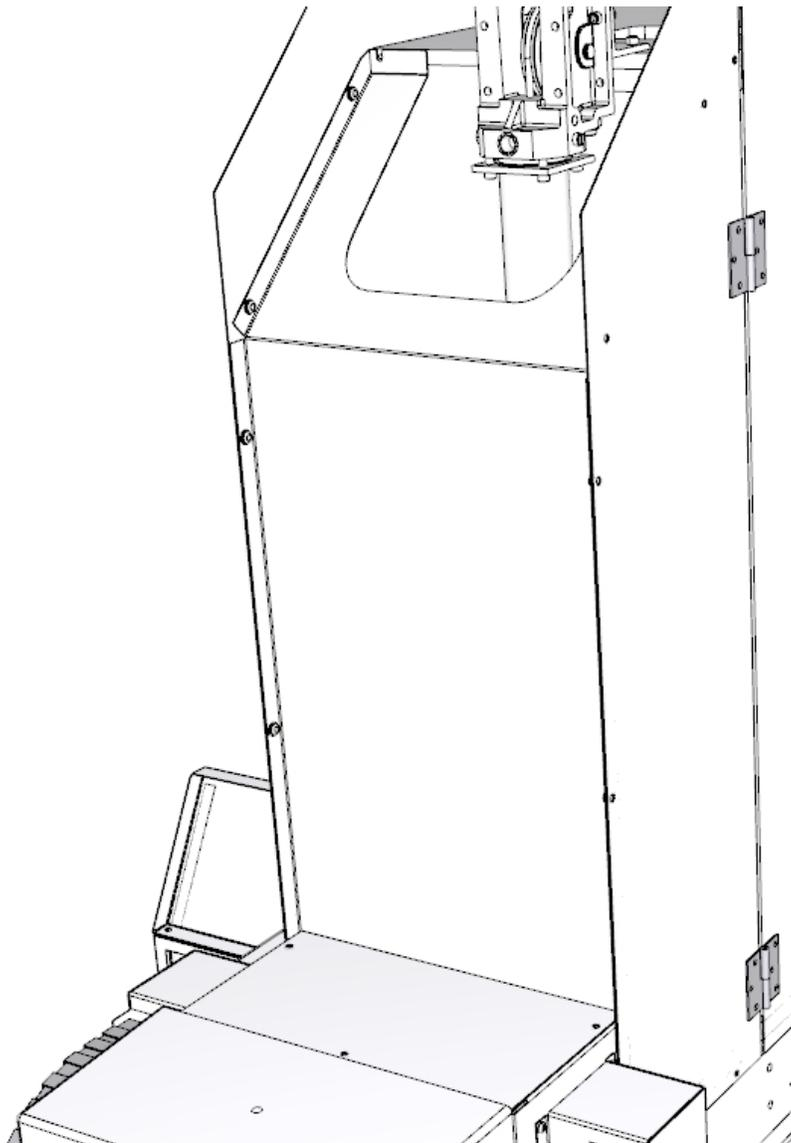
11. Dévissez l'assemblage du cylindre de la plaque de base de la tour et installez le nouveau cylindre.
