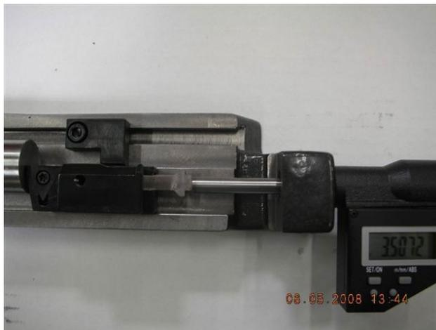
Le micromètre est maintenant réglé pour être utilisé avec ce porte-outil.
