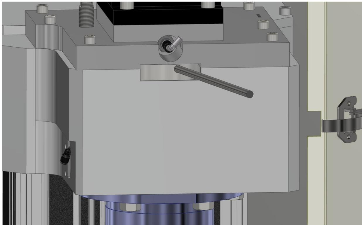
Tournez maintenant le porte-outil dans le sens des aiguilles d'une montre jusqu'à ce que vous sentiez que la bille de détente de l'écrou de réglage se bloque en place.
