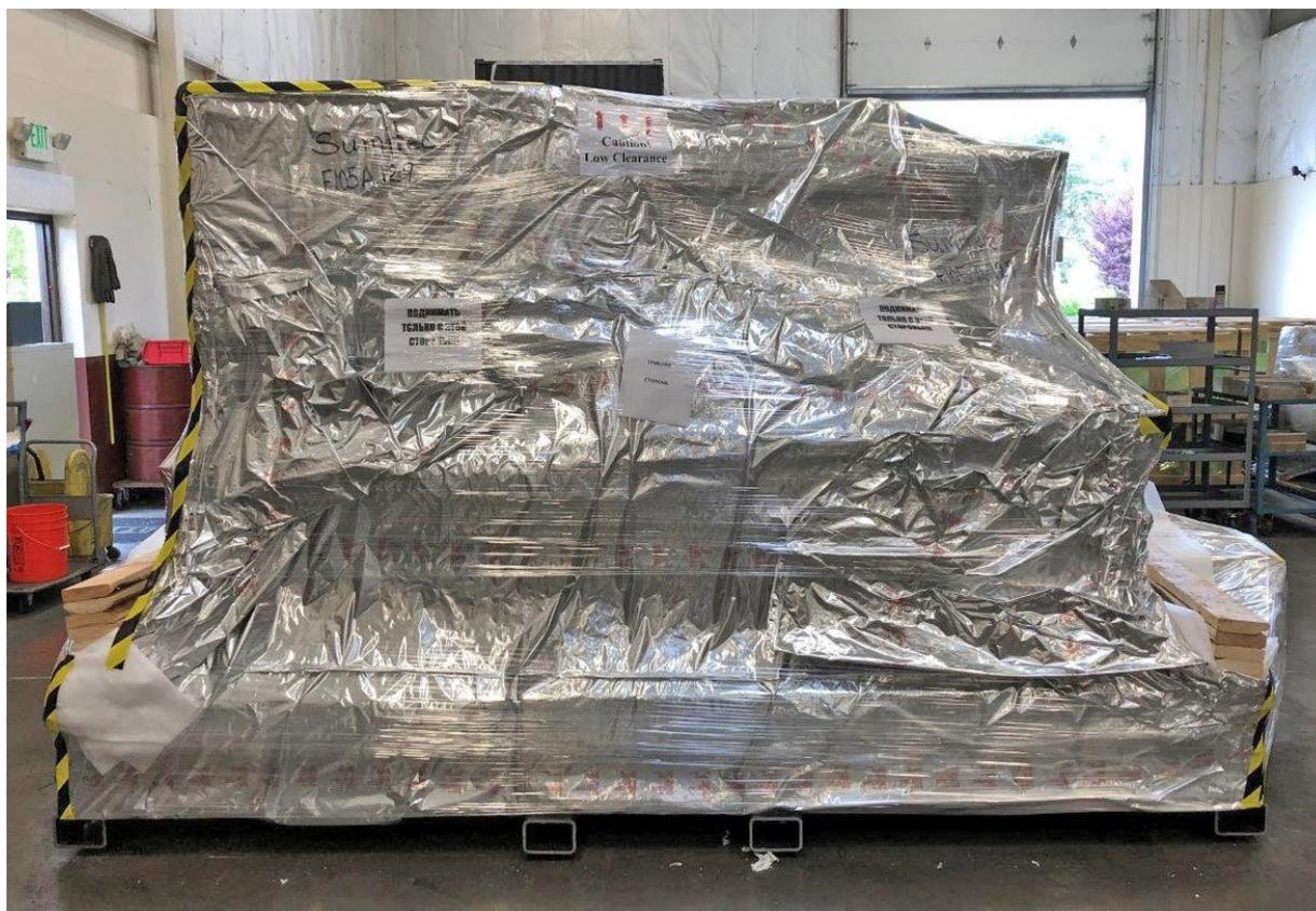
Les photos ci-dessous montrent les tubes sur lesquels repose la machine. Placez des sangles ou des chaînes dans ces tubes pour sortir la machine du conteneur. Veillez à ne pas endommager le filetage des boulons qui maintiennent les tubes sur la machine.
