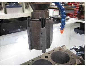
Rimuovere la testa dell'affilatura e pulire l'abrasivo. Osservare attentamente l'abrasivo per determinare se c'è una linea di contatto solida su tutta la lunghezza dell'abrasivo. Se non c'è una linea di contatto solida né sul bordo di entrata né su quello di uscita dell'abrasivo, ripetere l'operazione.
