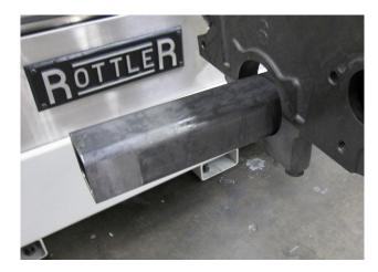
Utilizzare un metodo appropriato per posizionare il blocco sulle parallele dell'alzata con la parte anteriore del blocco rivolta verso sinistra o lontano dal pendente di comando.
