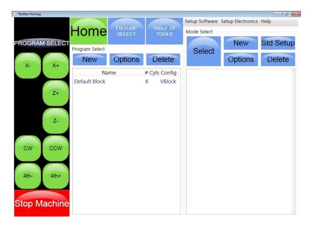
Questa è la schermata iniziale. Utilizzando i pulsanti jog, toccare il pulsante X+ per spostare il carrello sul lato destro della macchina. Toccare il pulsante Z+ per sollevare il mandrino fino in cima. Ora la macchina si trova nella posizione di caricamento dei blocchi. Attivare l'E-STOP premendo l'interruttore rosso E-STOP.
