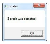
Se viene rilevato un punto di interferenza, la macchina si arresta e viene visualizzata una schermata a comparsa sullo schermo.
