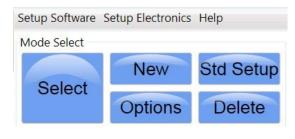
I titoli dei menu Setup Software e Setup Electronics aprono nuovi menu di opzioni. Questi sono utilizzati principalmente per l'impostazione della macchina in fabbrica o per l'assistenza. Se necessario, l'operatore può selezionare 2 opzioni, che verranno spiegate più avanti.
