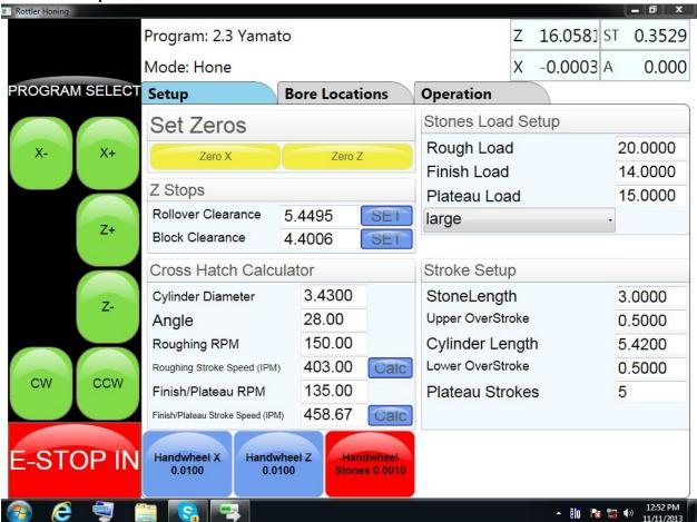
Nella parte superiore dello schermo viene visualizzato il blocco e il processo selezionato. Nella parte superiore destra è presente una lettura della posizione attuale dei diversi assi. *Tutte le letture sono in più o in meno rispetto ai punti di azzeramento.* (La lettura dell'asse A in questo caso è il quarto asse e mostra una lettura solo se è installato il dispositivo di rotazione automatica opzionale).
