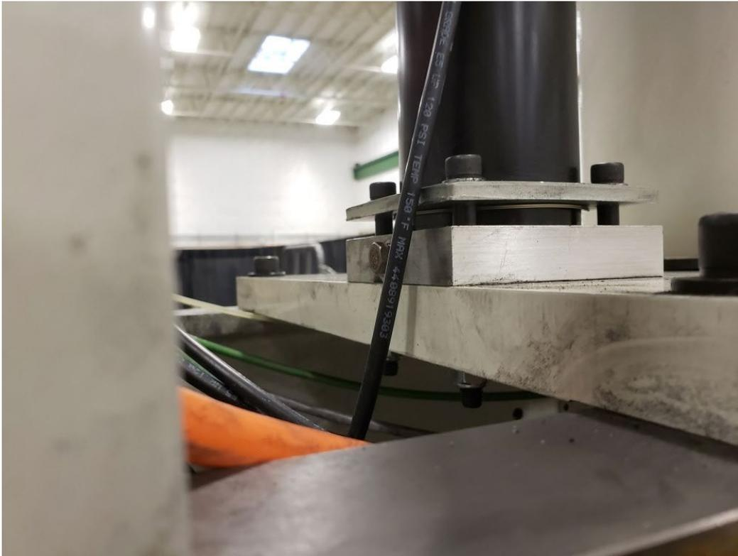
12. Den oberen Teil des Zylinders an der Halterung der oberen Platte festschrauben und die obere Abdeckung wieder anbringen.
