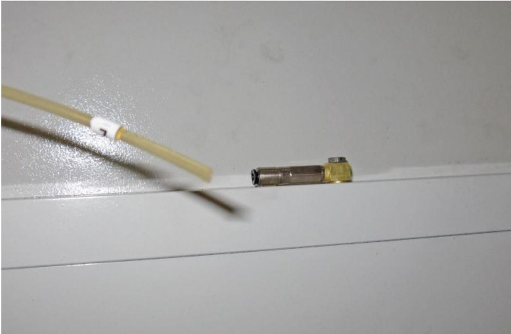
3. Schalten Sie das IO-Bit für den Öler am Computer ein und warten Sie, bis Öl aus der Leitung fließt.
