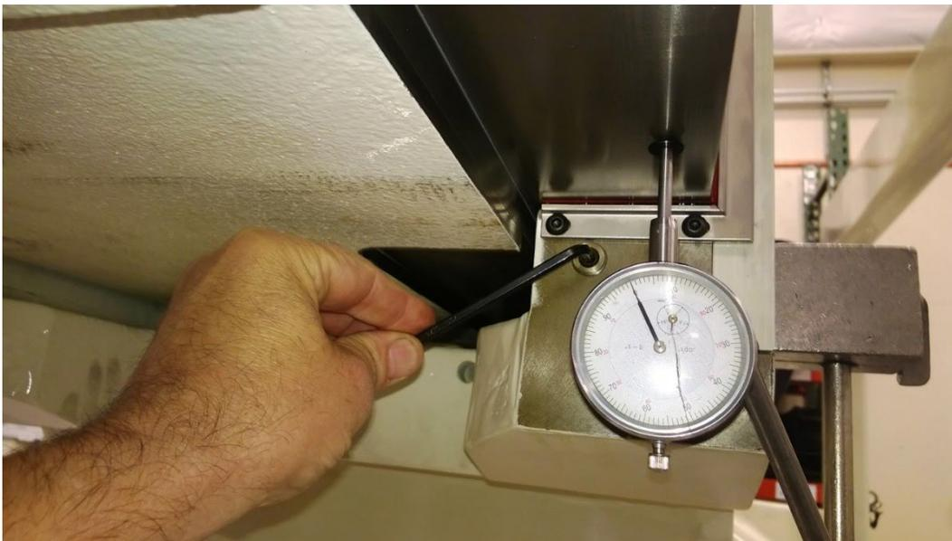
3. Drehen Sie die Einstellschraube mit einem 3/16"-Inbusschlüssel gegen den Uhrzeigersinn, um die Neigung des Fräasers zu erhöhen oder zu verringern. Drücken Sie nach jeder Einstellung die Taste "Wedge On", um den Wert zu überprüfen. Stellen Sie den Hubbetrag auf einen Wert zwischen 0,002 und 0,004" (0,05-0,10 mm) ein. Schalten Sie den Keil zum Nachjustieren aus.
