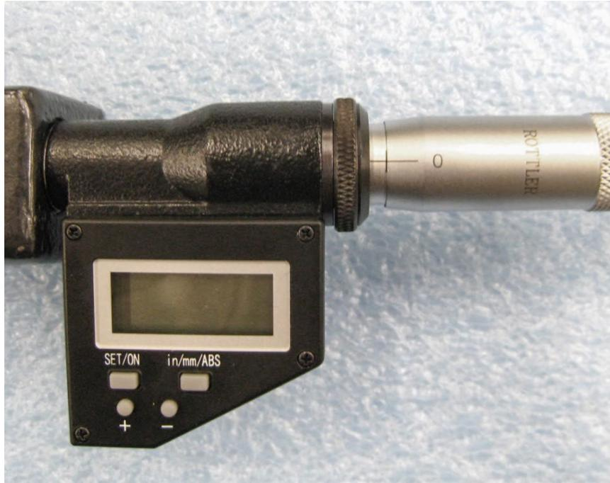
Bestimmen Sie den Bohrungsbereich des Messerkopfes, für den die Messschraube verwendet werden soll. (Beispiel: 2,9 - 6,0) Wir wollen die Messschraube zunächst auf den minimalen Bohrungsdurchmesser des Messerkopfes einstellen.
