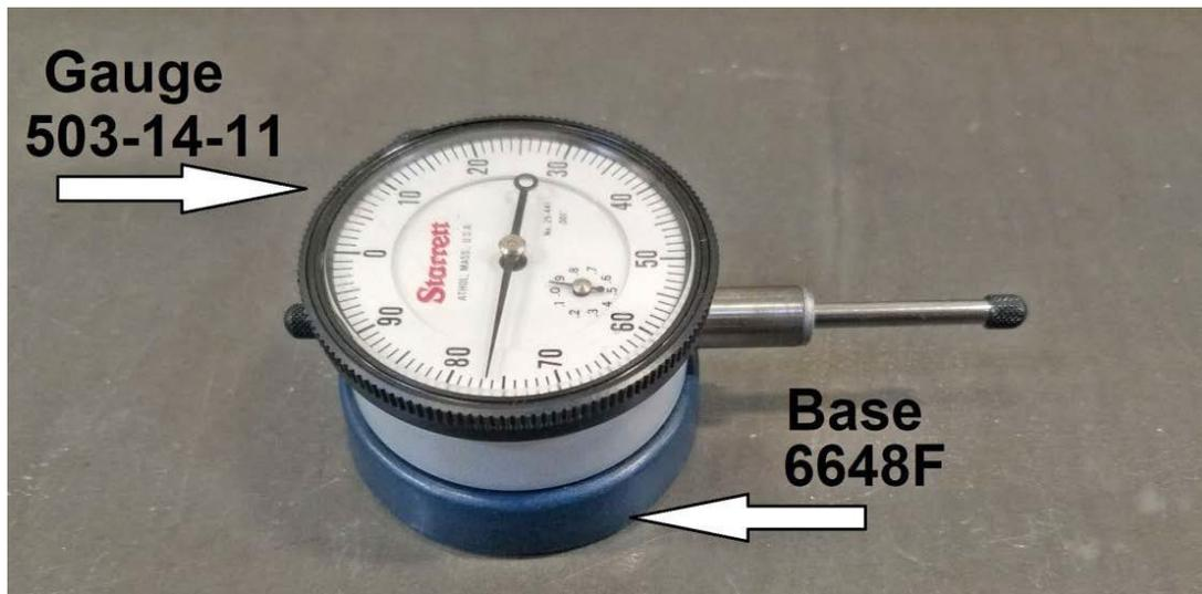
Wenn die Achse überschießt oder langsam in die Position kommt, können Sie dies mit einer Messuhr erkennen. Mit der Digitalanzeige sehen Sie nur die Endposition. Die Magnascale-Anzeige sollte zum Einstellen oder Einfahren verwendet werden. Die automatischen Bewegungen der Maschine können den empfindlichen Stößel der Magnascale "erschüttern".
