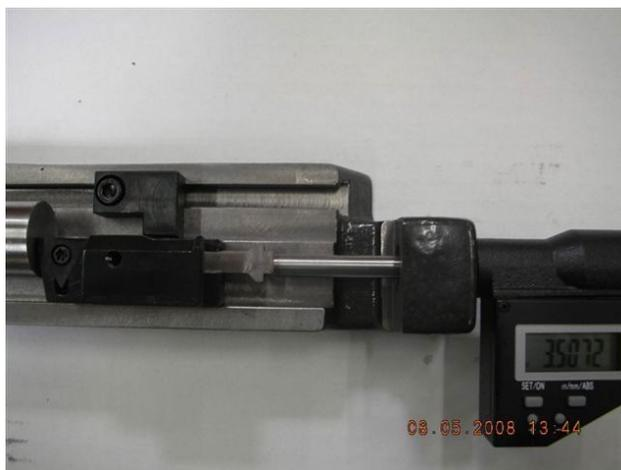
Die Messschraube ist nun für die Verwendung mit diesem Messerkopf eingerichtet.
