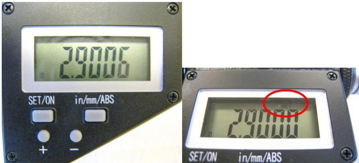
Halten Sie die Taste set/on und die Taste + oder - gleichzeitig gedrückt. Auf der Anzeige blinkt "Set". Dadurch wird die Messschraube in den Bearbeitungsmodus versetzt. (ACHTUNG: Verwenden Sie eine Bleistiftspitze oder etwas Ähnliches, um die kleinen runden Tasten vorsichtig zu drücken - sie sind recht klein und etwas empfindlich).
