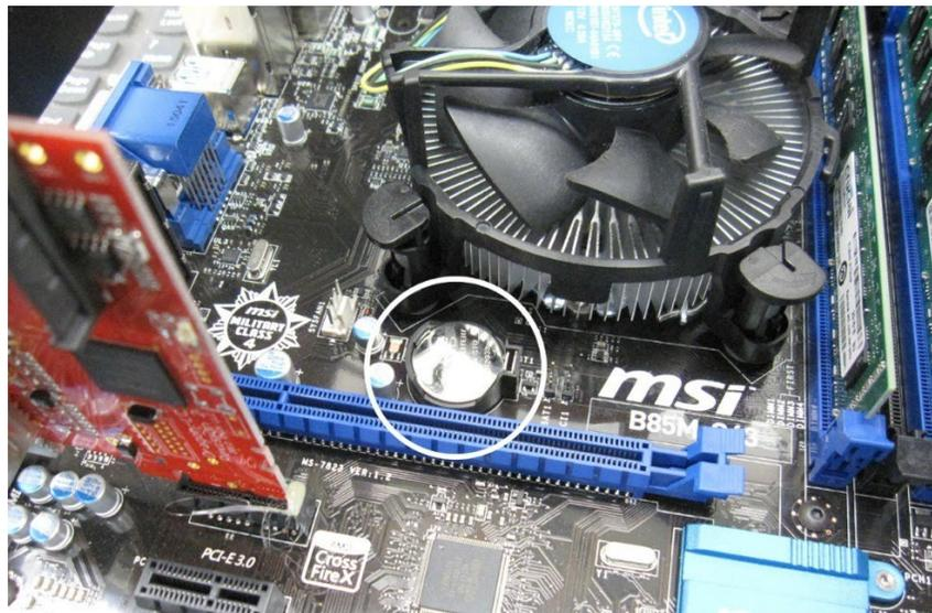
Empuje el clip de retención de la batería hacia fuera. Al soltar el clip, la batería saldrá hacia arriba.
