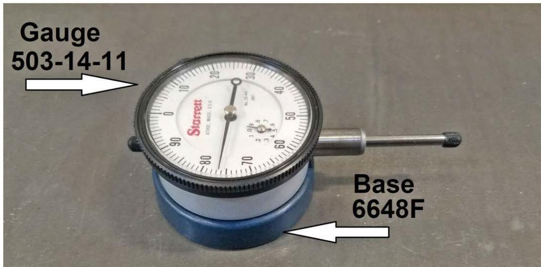
Si el eje se sobrepasa o se posiciona lentamente, podrá verlo con un reloj comparador. Con el indicador digital sólo verá la posición final. El indicador Magnascale debe utilizarse para marcar o trampear. Los movimientos automáticos de la máquina pueden "sacudir" el émbolo sensible del Magnascale.
