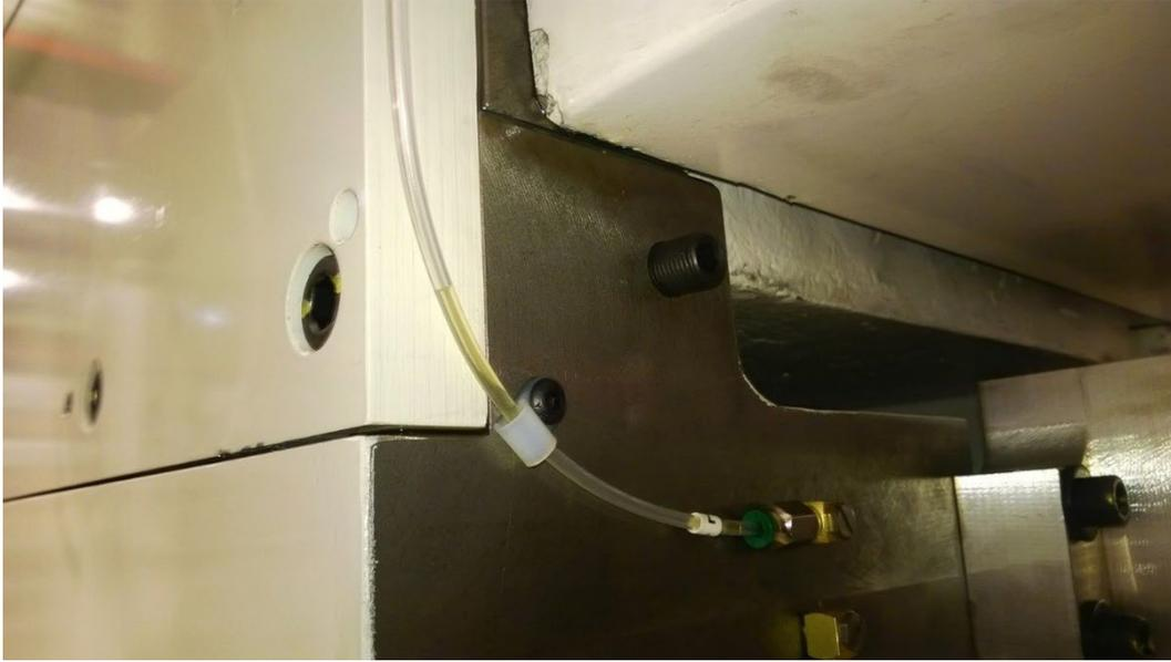
6. Después de ajustar la cuña trasera, vuelva a comprobar la delantera para asegurarse de que no ha cambiado.
