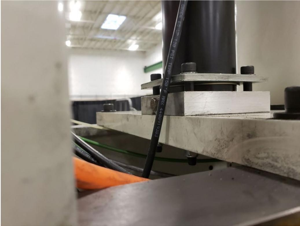
12. Atornille la parte superior del cilindro al soporte de la placa superior y vuelva a instalar la cubierta superior.
