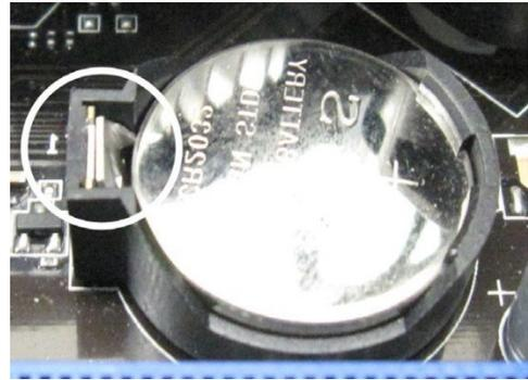
Retire la pila y coloque una nueva en el portapilas.
