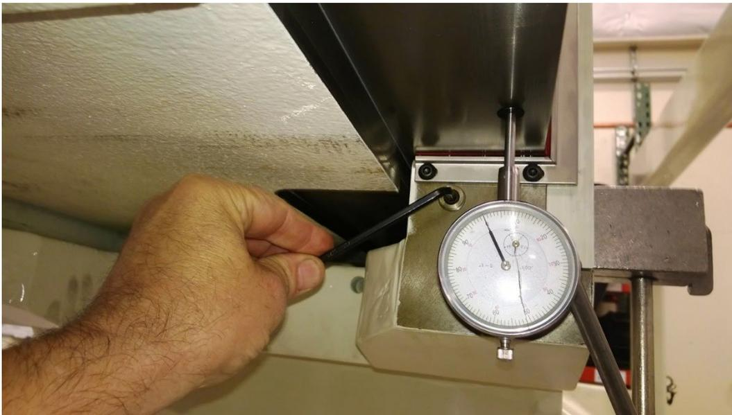
3. Usando una llave hexagonal de 3/16", gire el tornillo de ajuste CCW para aumentar o CW disminuir la cantidad de inclinación del molino. Después de cada ajuste, pulse el botón "Wedge On" para comprobar la cantidad. Ajuste la cantidad de elevación entre 0,002 y 0,004" (0,05-0,10 mm). Apague la cuña para reajustar.
