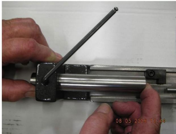
Coloque el portaherramientas utilizado para taladrar el orificio en el bastidor del micrómetro. Deslice suavemente la protuberancia de localización de la parte posterior del portaherramientas contra el extremo del eje del micrómetro digital.
