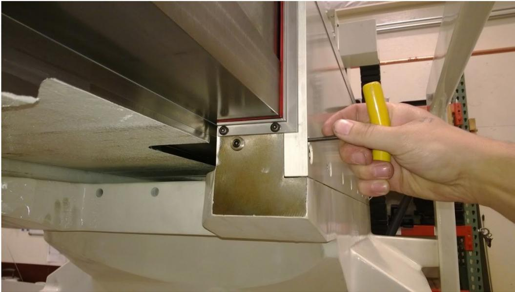
2. Ponga la máquina en modo "Ciclo de fresado", con la cuña apagada. Coloque un indicador como se muestra en la siguiente foto, y póngalo a cero
