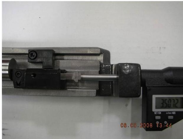
El micrómetro está ahora preparado para su uso con este cabezal de corte.
