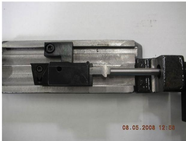
Deslice el yunque de gran diámetro hacia arriba hasta que toque el extremo de la punta de corte del portaherramientas. Apriete el tornillo de fijación.
