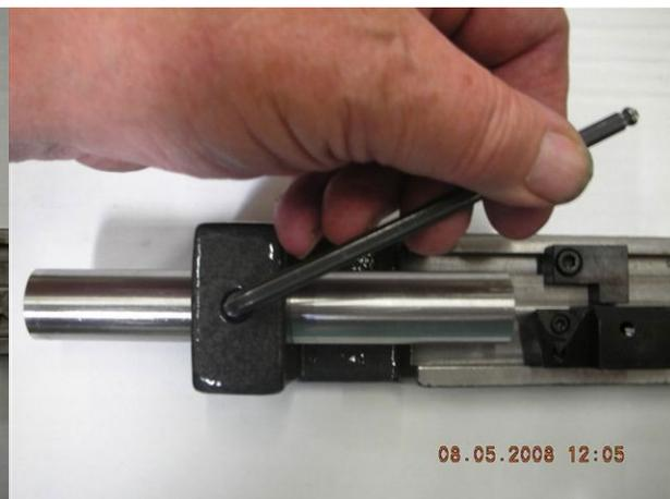
Retire el eje del micrómetro digital y, a continuación, súbalo hasta tocar el portaherramientas y vuelva a comprobar que los números que aparecen en la pantalla coinciden con los mostrados anteriormente.
