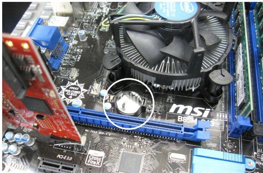
Drücken Sie den Batteriehalterungsclip von der Batterie weg. Wenn der Clip gelöst wird, springt der Akku heraus.
