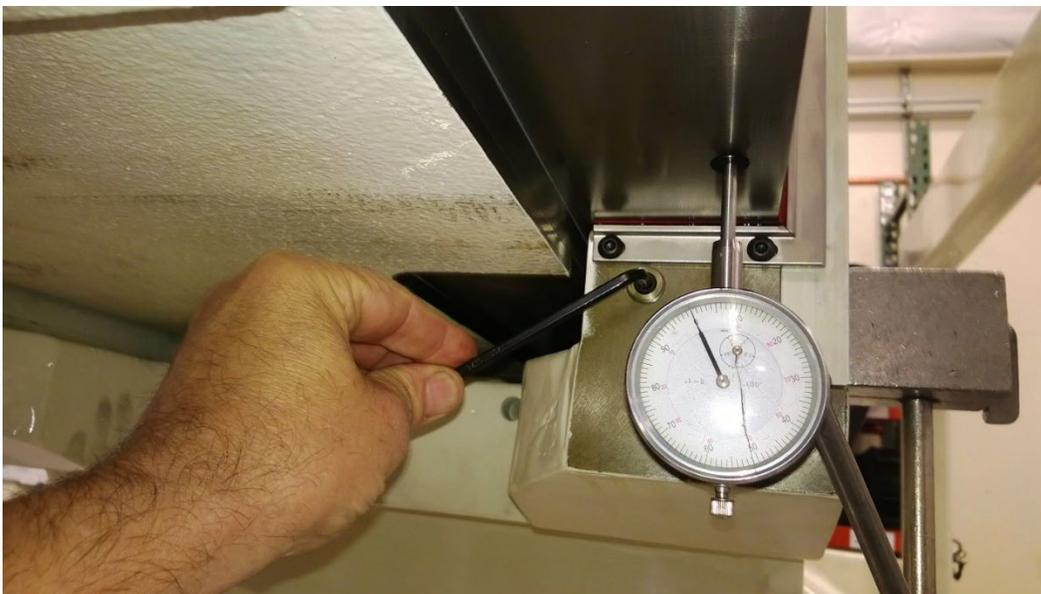
3. Drehen Sie die Einstellschraube mit einem 3/16-Zoll-Inbusschlüssel gegen den Uhrzeigersinn, um die Neigung des Fräasers zu erhöhen oder zu verringern. Drücken Sie nach jeder Einstellung die Taste "Wedge On", um den Wert zu überprüfen. Stellen Sie den Hubbetrag auf einen Wert zwischen 0,002 und 0,004" (0,05-0,10 mm) ein. Schalten Sie den Keil zum Nachjustieren aus.
