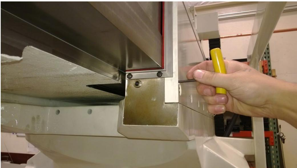
2. Schalten Sie die Maschine in den Modus "Fräszyklus", wobei der Keil ausgeschaltet ist. Bringen Sie einen Indikator an, wie auf dem folgenden Foto gezeigt, und stellen Sie ihn auf Null
