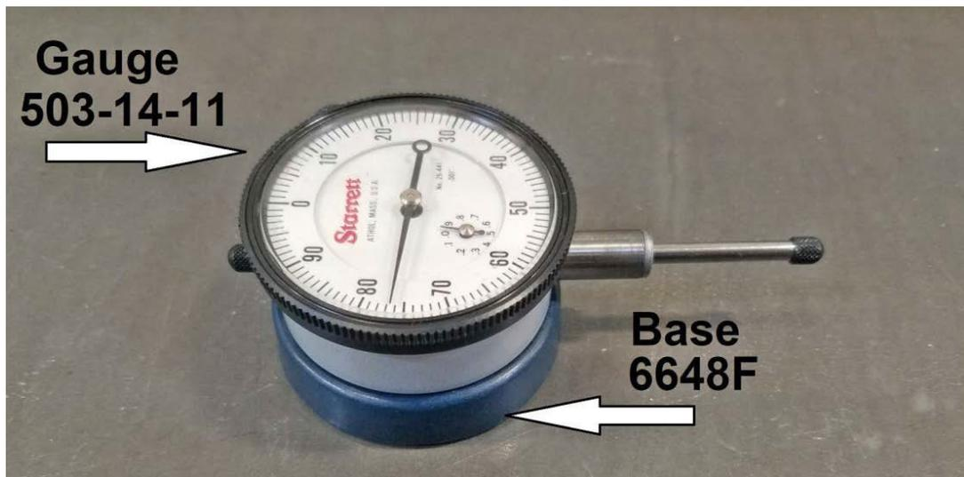
Wenn die Achse überschießt oder nur langsam in Position kommt, können Sie dies mit einer Messuhr erkennen. Mit der Digitalanzeige sehen Sie nur die Endposition. Die Magnascale-Anzeige sollte zum Einstellen oder Einfahren verwendet werden. Die automatischen Bewegungen der Maschine können den empfindlichen Stößel der Magnascale "erschüttern".
