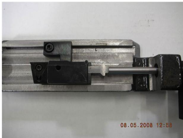
Schieben Sie den Amboss mit dem großen Durchmesser nach oben, bis er das Ende der Schneidspitze des Werkzeughalters berührt. Ziehen Sie die Stellschraube an.
