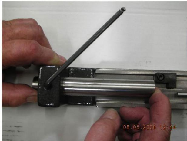
Setzen Sie den Werkzeughalter, mit dem Sie das Loch gebohrt haben, in den Mikrometerrahmen ein. Schieben Sie den Aufnahme­knopf auf der Rückseite des Werkzeughalters leicht gegen das Ende der Welle der digitalen Bügelmessschraube drücken.
