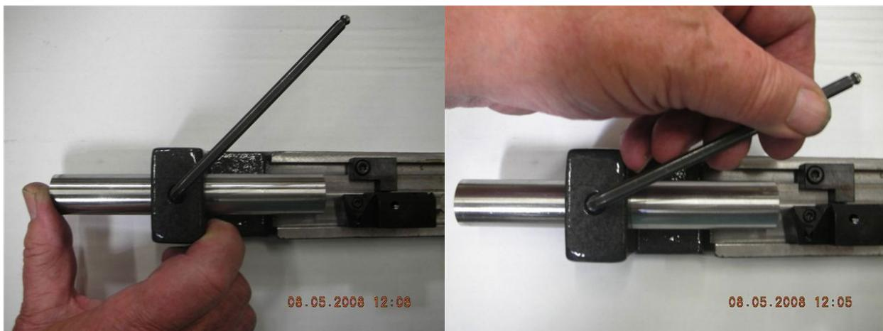
Ziehen Sie die digitale Messschraube zurück, berühren Sie mit ihr den Werkzeughalter und überprüfen Sie, ob die Zahlen auf dem Display die gleichen wie die zuvor angezeigten.
